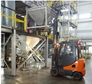
При загрузке в систему 2 м<sup>3</sup> катализатора с использованием бочек, бочкокантователя и промежуточного бункера выполняется **12 циклов** подъема/опускания погрузчиком
